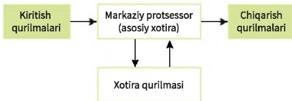
2.01-rasm. Kompyuter tizimining asosiy komponentlari.
